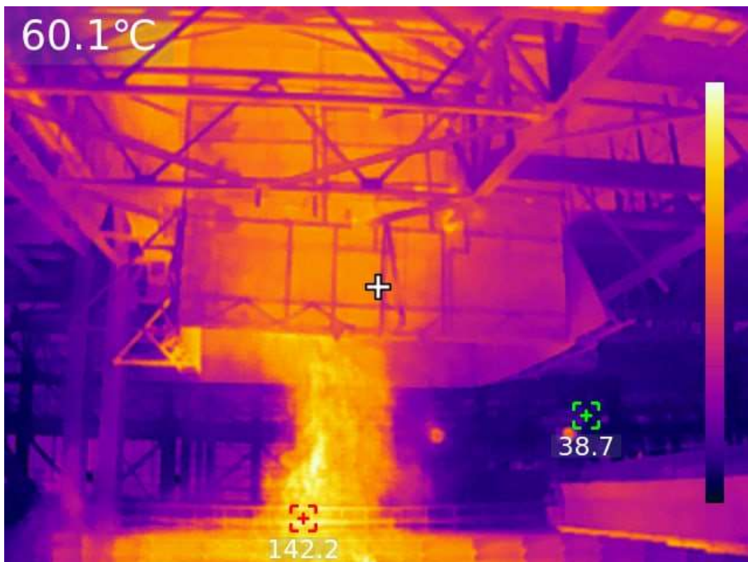
61-rasm. Gaz chiqarish tizimi – issiqlik taqsimoti (termovizor tasviri) Manba: joyida o‘tkazilgan termovizion tahlil natijasi.
