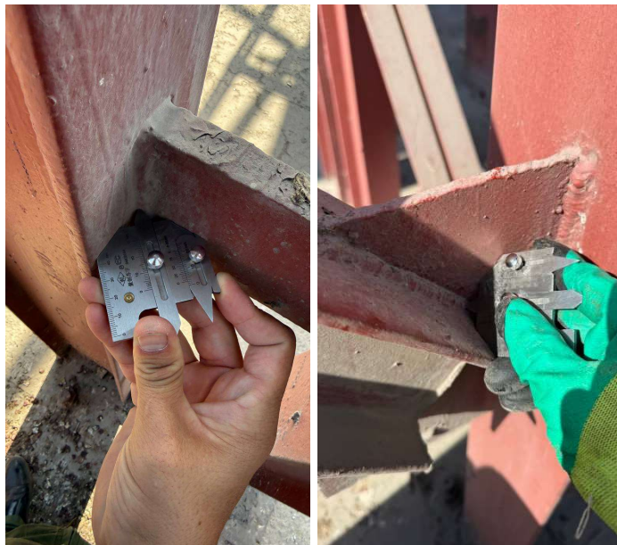
24-rasm. Metall konstruksiyaning payvand choklarini nazorat qilish jarayoni
