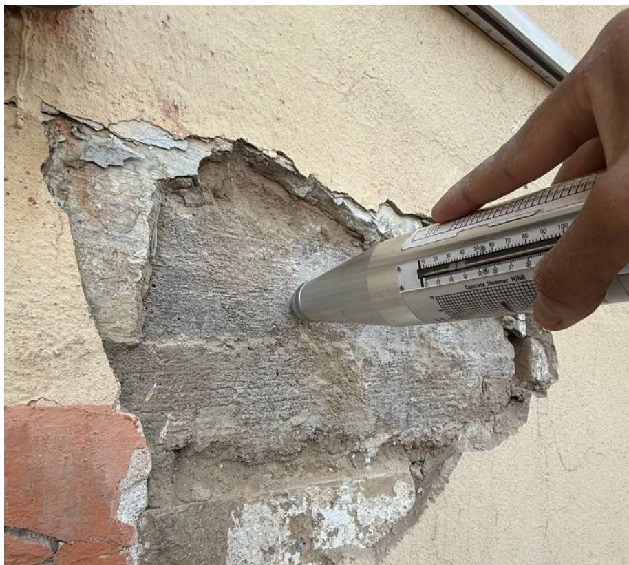
Фото 4. Определение прочности перемычки двери прибором Шмидт, средняя прочность материала фактически составила класс В15.
